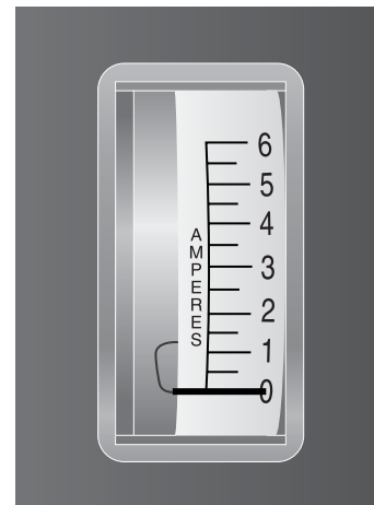
Abb. 8. Amperemeter (zeigt Vollgeladene Batterien an)
